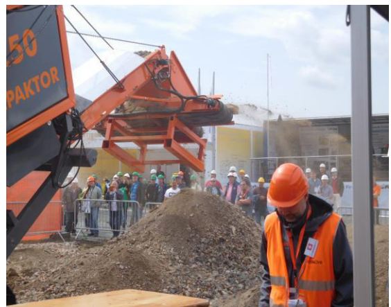
Слика 5.2.8-3. Машина/постројење за третман отпада од рушења и грађења (дробилица, магнетни сепаратор - слика лево и сито на крају конвејера (слика десно)
