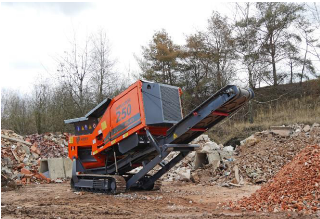
Слика 5.2.8-3. Машина/постројење за третман отпада од рушења и грађења (дробилица, магнетни сепаратор - слика лево и сито на крају конвејера (слика десно)
