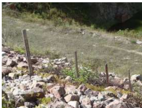
Слика ЕМР.13. Водомерне летве за мерење водостаја водосабирног језера
