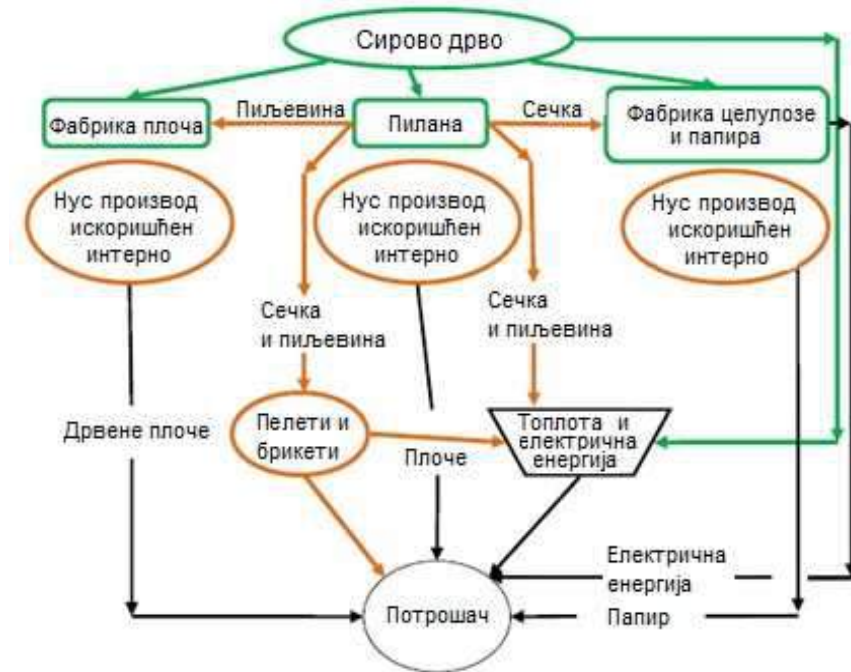
Слика 11. – Ток производа и нус производа у индустрији прераде дрвета
