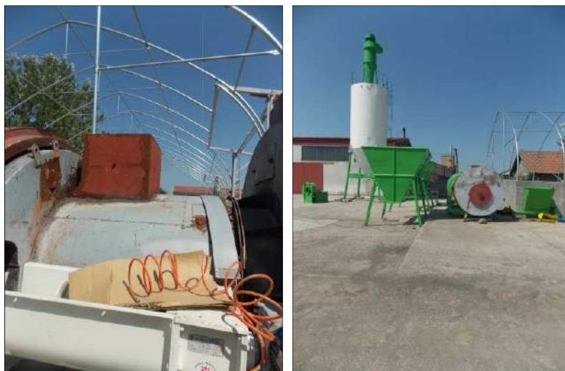
Слика 14. – Машина за уситњавање дрвета „Chipper“ (лево) и силос за влажну сечку (десно)
